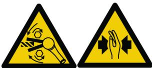
在开始前务必检查工具转动方向！在意外转动方向下启动可能会造成严重的人身伤害或财产损失。活动部件可能导致压伤和割伤。
