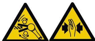
Inspeccione a direção de rotação da ferramenta antes de começar! Ligar a ferramenta em uma direção de rotação inesperada pode provocar acidentes ou danos materiais. Peças em movimento podem provocar esmagamento e cortes.
