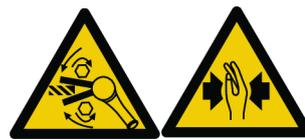
Vor dem Start die Drehrichtung des Werkzeugs prüfen. Ein Start in eine unerwartete Drehrichtung kann zu Verletzungen und Sachschäden führen. Bewegliche Teile stellen eine Quetsch- und Schnittgefahr dar.
