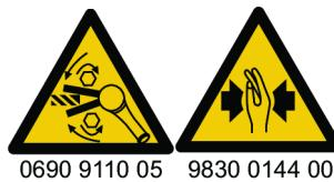
始動前に回転方向を確認してください！予期しない回転方向に動き出すと、負傷や物的損害が発生するおそれがあります。可動部品によって押しつぶされて切断されるおそれがあります。
