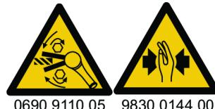
Pred spustením vykonajte kontrolu smeru otáčania nástroja! Spustenie v neocakávanom smere otáčania môže spôsobiť telesné zranenie alebo poškodenie majetku. Pohyblivé diely môžu spôsobiť pomliaždenie a porezanie.
