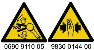
Przed uruchomieniem narzędzia należy sprawdzić kierunek jego obrotów! Uruchomienie narzędzia w nieoczekiwany kierunku może spowodować obrażenia ciała lub szkody materialne. Ruchome części mogą spowodować zmiażdżenia i skałeczenia.
