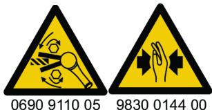
Vor dem Start die Drehrichtung des Werkzeugs prüfen. Ein Start in eine unerwartete Drehrichtung kann zu Verletzungen und Sachschäden führen. Bewegliche Teile stellen eine Quetsch- und Schnittgefahr dar.
