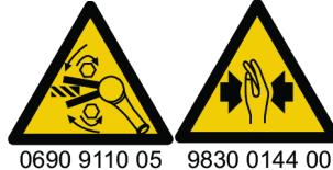
Ellenőrizze a szerszám forgási irányát, mielőtt elindítaná! A szerszámgyep hirtelen elindulása a nem várt forgási irányban súlyos személyi sérülést és a tulajdon károsodását okozhatja. A mozgó alkatrészek zúzódásos és vágásos sérüléseket okozhatnak.
