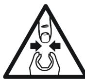
Bu alet ile açık uçlu bir ön parçasının kullanılması parmakların ve ellerin ezilmesine neden olabilir.
