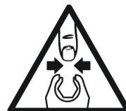
Om du använder en främre del med öppen ände tillsammans med detta verktyg kan det leda till att fingrar och händer kläms.
