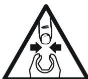
L'utilisation d'une pièce frontale à renvoi d'axe ouvert avec cet outil peut entraîner l'écrasement des doigts et des mains.
