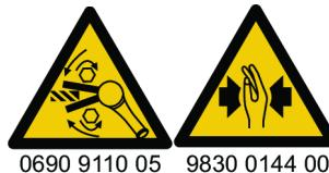
Inspecione a direção de rotação da ferramenta antes de começar! Ligar a ferramenta em uma direção de rotação inesperada pode provocar acidentes ou danos materiais. Peças em movimento podem provocar esmagamento e cortes.
