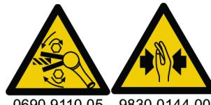
Przed uruchomieniem narzędzia należy sprawdzić kierunek jego obrotów! Uruchomienie narzędzia w nieoczekiwany kierunku może spowodować obrażenia ciała lub szkody materialne. Ruchome części mogą spowodować zmiażdżenie i skałczanie.
