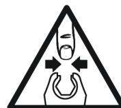
Utilizar una pieza delantera de boca abierta con esta herramienta puede causar el aplastamiento de dedos y manos.
