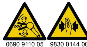
Před spuštěním zkонтrolujte směr otáčení nástroje! Spuštění nástroje s neočekávaným směrem otáčení může mít za následek úraz nebo škodu na majetku. Pohyblivé části mohou drtit a řezat.
