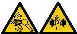
Foreta en kontroll av rotasjonsretningen til verktøyet før start! En start i en uventet rotasjonsretning kan forårsake personskade eller materielle skader. Bevegelige deler kan knuse og kutte.
