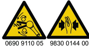
Procéder à un contrôle du sens de rotation de l'outil avant de démarrer ! Un démarrage dans un sens de rotation inattendu peut provoquer des accidents corporels ou des dégâts matériels. Les pièces mobiles peuvent broyer et couper.
