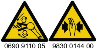
始動前に回転方向を確認してください！予期しない回転方向に動き出すと、負傷や物的損害が発生するおそれがあります。可動部品によって押しつぶされて切断されるおそれがあります。
