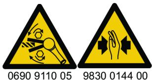
Kontrollér værktøjets rotationsretning før start! Start i en uventet rotationsretning kan forårsage lisioner eller beskadigelse af ejendom. Bevægelige dele kan knuse og skære.
