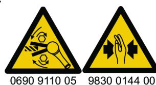
Eseguire un controllo della direzione di rotazione dell'utensile prima dell'avvio! Un avvio in una direzione di rotazione imprevista può causare lesioni o danni. Le parti mobili possono schiacciare e tagliare.
