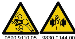
Prije početka rada provjerite smjer okretanja alata! Pokretanje u neočekivanom smjeru okretanja može prouzročiti tjelesnu ozljedu ili imovinsku štetu. Pokretni dijelovi mogu zdrotiti i preseći.
