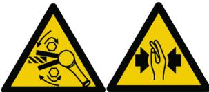
Перед началом работы проверьте направление вращения инструмента! Запуск с неправильным направлением вращения может привести к травмам или материальному ущербу. Движущиеся части могут раздавить или порезать.
