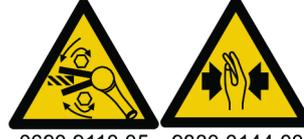
Başlamadan önce aletin dönüş yönünü kontrol edin! Beklenmedik bir dönüş yönünde başlangıç bedensel yaralanmaya veya maddi zarara neden olabilir. Hareketli parçalar ezilme ve kesilmeye neden olabilir.
