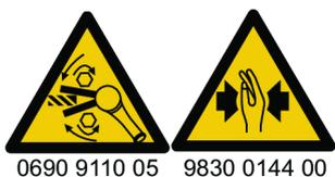
Pred spustením vykonajte kontrolu smeru otáčania nástroja! Spustenie v neočakávanom smere otáčania môže spôsobiť telesné zranenie alebo poškodenie majetku. Pohyblivé diely môžu spôsobiť pomliaždenie a porezanie.
