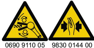
始動前に回転方向を確認してください！予期しない回転方向に動き出すると、負傷や物的損害が発生するおそれがあります。可動部品によって押しつぶされて切断されるおそれがあります。
