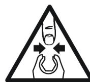
Die Verwendung eines offenen Vorderteils mit diesem Werkzeug kann Quetschungen an Fingern und Händen verursachen.
