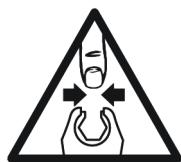
Użycie otwartej części przedniej z tym narzędziem może spowodować zmiażdżenie palców i dloni.
