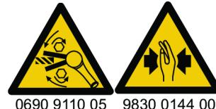
Kontrollér værktøjets rotationsretning for start! Start i en uventet rotationsretning kan forårsage læsioner eller beskadigelse af ejendom. Bevægelige dele kan knuse og skære.
