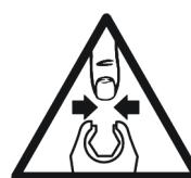
Použití otevřeného předního dílu s tímto nástrojem může způsobit rozdrcení prstů a rukou.
