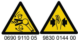
Przed uruchomieniem narzędzia należy sprawdzić kierunek jego obrotów! Uruchomienie narzędzia w nieoczekiwany kierunku może spowodować obrażenia ciała lub szkody materialne. Ruchome części mogą spowodować zmiażdżenia i skałczania.
