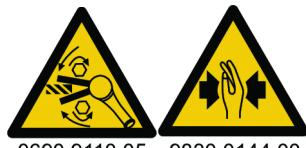
Antes de comenzar a trabajar, compruebe la dirección de giro de la herramienta. Si se desconoce la dirección de giro pueden provocarse lesiones personales o daños materiales. Las partes móviles pueden aplastar y cortar.
