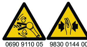
Před spuštěním zkonzolujte směr otáčení nástroje! Spuštění nástroje s neočekávaným směrem otáčení může mít za následek úraz nebo škodu na majetku. Pohyblivé části mohou drtit a řezat.
