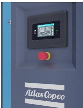
Elektronikon®を使用すると、タブレットやスマートフォンなどのモバイル機器にコントローラを簡単に接続できます。弊社の「SMARTLINKシステム」を使用することで、安全なネットワークを介したモバイルモニタリングが可能です。モニタリングすることはコストを節約するだけでなく、故障や生産損失を回避することに繋がります。
