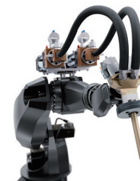
ビジョン検査装置付き2液接着剤/ギャップファイラー塗布装置
