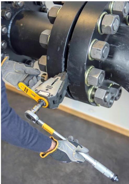
*Ein von Hand problemlos aufzubringendes Drehmoment von nur 180 Nm setzt der Flanschspreizer ACMS 08T in eine Spaltkraft von umgerechnet 8 t um. Das hydraulisch angetriebene Schwestermodell ACHS 14T schafft sogar 14 t. Die neuen Spreizer vereinfachen Wartungs- und Reparaturarbeiten an Rohrleitungen mit Festflanschverbindung und machen sie sicherer. (Bild: Atlas Copco Tools)*
