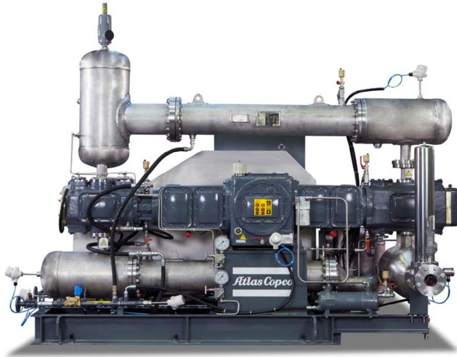
*Mit den CO<sub>2</sub>-Kolbennachverdichtern von Atlas Copco lässt sich Kohlendioxid, das zum Beispiel in Brauereien oder in chemischen Prozessen anfällt, auf einen Betriebsüberdruck von 11 bis 20 bar komprimieren. Das Gas kann dann – auch an anderer Stelle – wiederverwertet werden. (Bild: Atlas Copco)*
