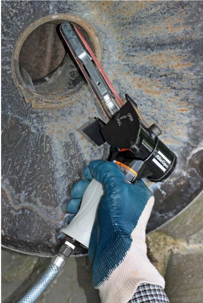
*Der neue Bandschleifer G2420 aus der PRO-Serie von Atlas Copco Tools erreicht mit seinen 19 mm x 520 mm großen Schleifbändern und dem langen serienmäßigen Kontaktarm verwinkelte und tiefliegende Stellen. Mit ihm lassen sich auch größere Oberflächen effizient und wirtschaftlich bearbeiten. (Bild: Atlas Copco Tools)*
