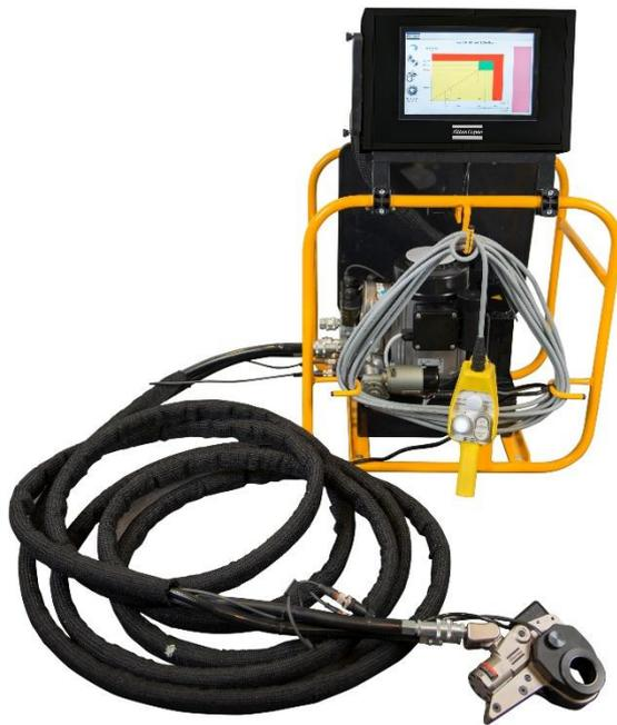
*Das neue RTA-Hydraulikschraubsystem mit Touch-Controller und direkt messendem Werkzeug eignet sich für Drehmomente bis zu 11000 Nm. (Bild: Atlas Copco Tools)*
