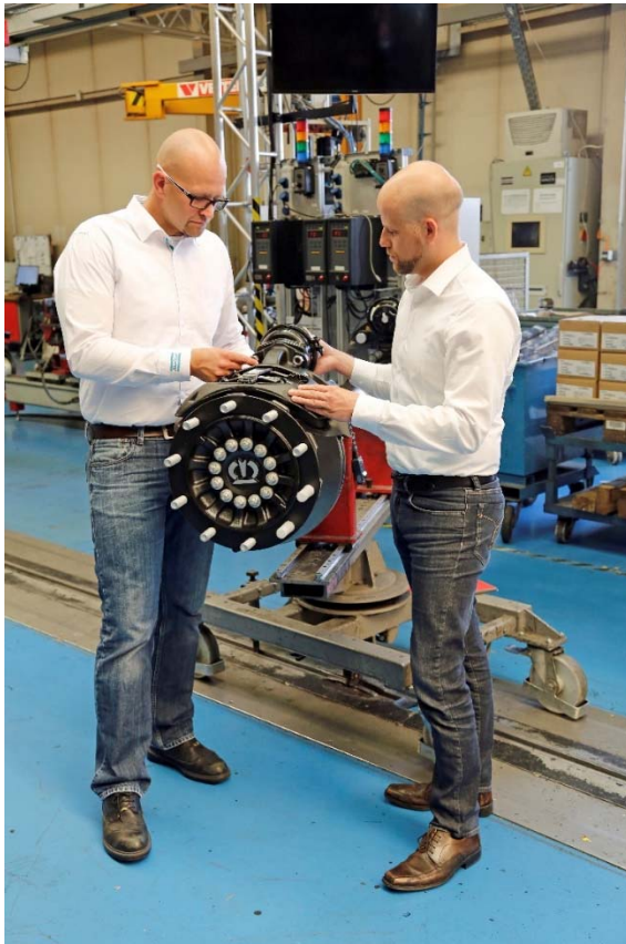
Begutachtung im Detail: Bremsaggregat und Nabe-Flansch-System werden mit Atlas-Copco-Schraubtechnik montiert. Im Hintergrund die Steuerungen verschiedener Tensor-Elektroschrauber. (Bild: Atlas Copco Tools)
