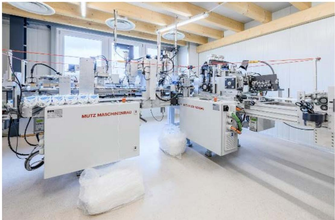
Bild 1: Einblick in die Schutzmaskenproduktion bei Mutz-Maschinenbau. Die vollautomatische Produktionslinie, liefert in einer Stunde 800 Schutzmasken
