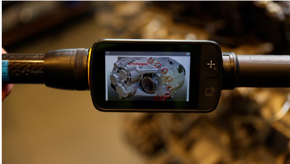
Der Qualitätsschlüssel STRwrench Advanced führt den Qualitätsprüfer sicher durch den Prüfprozess anhand der bildgestützten Bedieneranleitung. (Bild: Atlas Copco Tools Central Europe GmbH)
