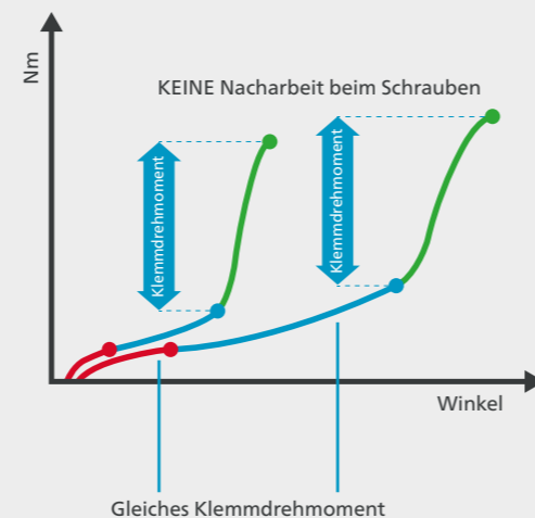
Korrektes Klemmdrehmoment angewendet – keine Nacharbeit erforderlich
