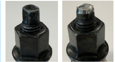
Diese Fotos zeigen eine unbenutzte und eine gebrochene Zweikant-Schraubenspitze.
