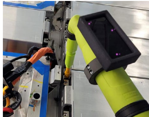
Galvanisch getrennter geführter Bithalter für ein Winkelkopfwerkzeug
