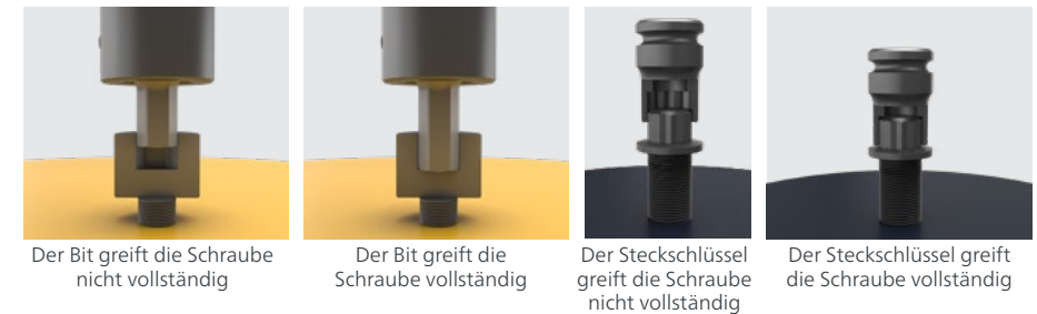
Steckschlüssel und Bits müssen die Schraube im gesamten Griffbereich greifen; unvollständiges Greifen ohne reduziertes Drehmoment kann zu gebrochenen Bits führen.
