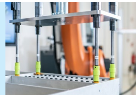
Beispiel für galvanisch getrennte QCAs bei einer Roboteranwendung
