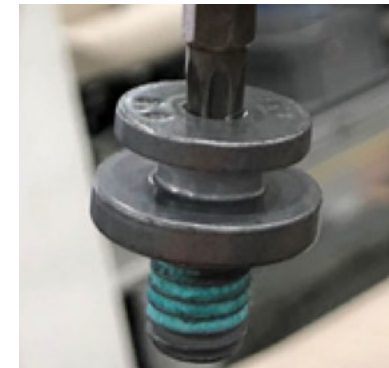
Steckschlüssel und Bits müssen die Schraube im gesamten Griffbereich greifen; unvollständiges Greifen ohne reduziertes Drehmoment kann zu gebrochenen Bits führen.
