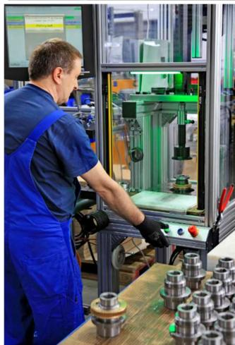
*PST-Servopressen sind bis zu 100 Kilonewton stark, energieeffizient, (prozess-)sicher und präzise. Bei der GfA ELEKTROMATEN GmbH haben sich diese Systeme schnell amortisiert. Hier ermöglichen die Elektropressen das kraftschlüssiges Verbinden von Getriebebauteilen mit höchster Wirtschaftlichkeit und ganz ohne Hydraulik.*
