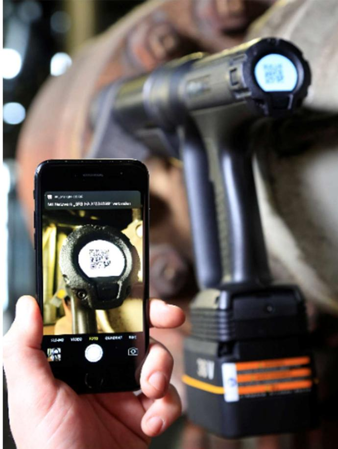
*Powered by Data. Die intelligent vernetzen Hochmoment-Akkuschrauber der SRB-HA-Serie von Atlas Copco Tools bieten eine Smart-Factory-Lösung für jeden Einsatzort. Es ist keine Steuerung und auch keine zusätzliche Software mehr nötig: Über jedes beliebige WLAN-fähige Endgerät können sich die Anwender mit dem SRB HA verbinden und den starken Schrauber denkbar leicht über einen Webbrowser konfigurieren. (Foto: Atlas Copco Tools Central Europe GmbH)*
