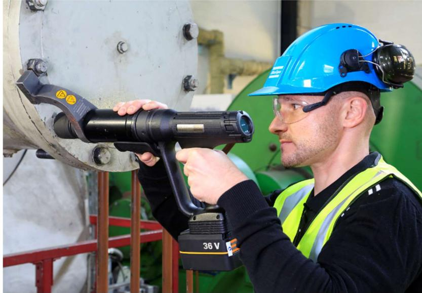
*'Smart Factory to go' – Die intelligenten SRB-HA-Werkzeuge von Atlas Copco Tools lösen kritische Schraubfälle bis 4000 Nm mit höchster Präzision und Prozesssicherheit an praktisch jedem Ort. (Foto: Atlas Copco Tools Central Europe GmbH)*
