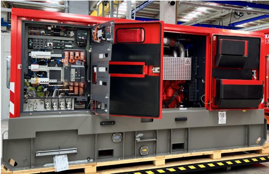
Ouvrir l'armoire de commande du groupe électrogène ATLAS COPCO
