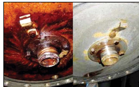
Bouchon cuve contaminée
