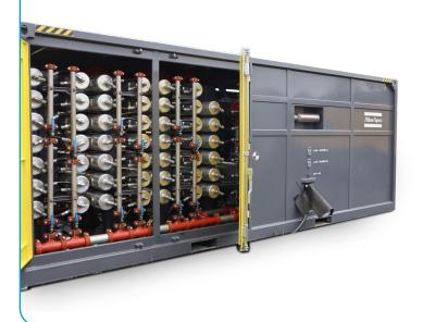
membrana e descartados do lado de fora ou em uma área segura. Isso deixa o  $N_2$  dentro das fibras ocas, pronto para ser coletado na saída. Com os vapores de água removidos, o nitrogênio produzido fica muito seco, o que é um benefício adicional para muitas aplicações. A eficiência desse processo de geração de nitrogênio baseado em membrana o torna uma tecnologia confiável e valiosa para diversas aplicações em ambientes difíceis.
